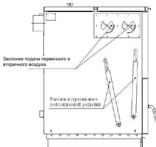
Рис. 19 Заслонки первичного и вторичного воздуха котла 80 кВт
